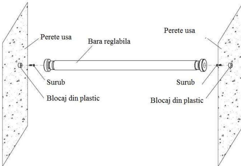
1. In functie de exercitii si statura, si de cat de lata este distanta dintre peretii usii, atasati blocajul din plastic pe lateralele usii folosind surubul. Cele 2 suruburi trebuie sa fie la acelasi nivel.
