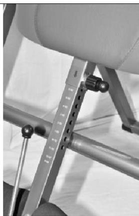
Inainte de a utiliza masa de inversie asigurati-va ca este reglata conform inaltimii dvs.(tija reglabila este prevazuta cu notatii).
