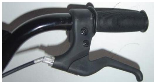
2. Introduceti cablul de frana in canelura surubului de reglare a manetei de frana si slabiti sabotii de frana.
