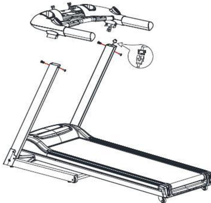
**Pas 4:** Atasati consola la suport si conectati cablurile. Folositi suruburile M6x25 pentru a fixa consola.
